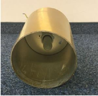
Beispiel einer Altbestandsleuchte ohne Reflektor
