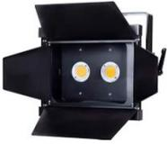
Kompakter Weißlichtfluter – einsetzbar als Konzert- und Probenlicht sowie als Arbeits- oder Grundbeleuchtung. Der Scheinwerfer ist lüfterlos und für den Dauereinsatz konzipiert. Die verwendeten Bridgelux LEDs fallen für den Augenschutz gemäß Norm EN62778 und EN62471 in die niedrigste Risikogruppe „RG1“ der photobiologischen Sicherheit.
