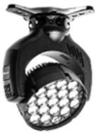
Der impression X4 ist mit 19 RGBW LEDs (à 15 Watt) und einer 7° – 50° Zoomoptik ausgestattet. Die verbaute Optik erlaubt es, einen klar definierten harten Beam im unteren Zoombereich darzustellen, und ist dabei im mittleren und oberen Zoombereich absolut homogen und weich. All das ohne störendes Streulicht. Saubere RGBW-Farbmischung, variables CTO und eine fein abgestimmte Dimmkurve sind im impression X4 Standard.
