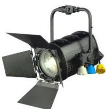
Der HYPERION 300 6C Fresnel-Scheinwerfer bietet sowohl Farblicht von satten Farben bis zu Pastelltönen. Zusätzlich kann er auch für Weißlicht eingesetzt werden. Handling, Qualität und Haptik erfüllen auch hohe Ansprüche. Die Leistungsklasse liegt im Bereich früherer 1kW bis 2kW-Halogencheinwerfer. Durch die Stangenbedienung (PO) sind die Scheinwerfer schnell und bequem vom Boden aus ohne Leiter einzurichten.
